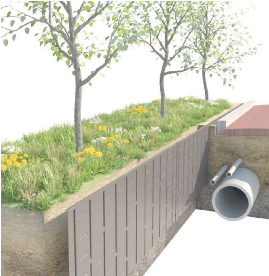
Slika 18: Prikaz proti-koreninske zaščite s ploščami.
