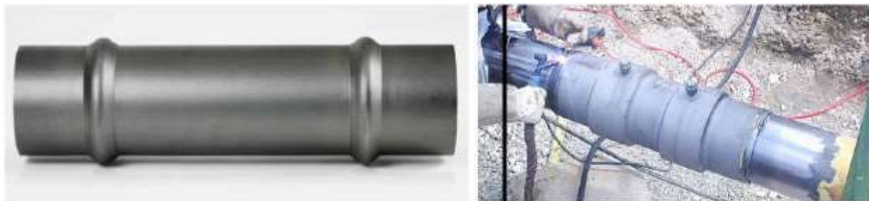
Slika 24: Prikaz Shuck SMH elementa in njegove vgradnje.
